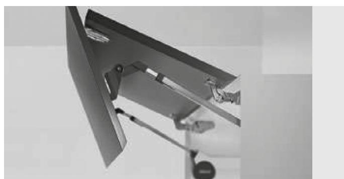
Öffnungsmechanismus für Höhen zwischen 72 und 120 cm, **BLUM AVENTOS HL TOP**, bei dem sich die Front parallel zur Vorderkante des Korpus öffnet. Leichtes Öffnen, in jeder Position arretierbar und sanftes, leises Schließen dank des BLUMOTION-Systems. Stabilität auch bei breiten Fronten. Optional SERVODRIVE (siehe Abschnitt 3.7). LGA-zertifiziert für über 40.000 Öffnungs- und Schließzyklen.
