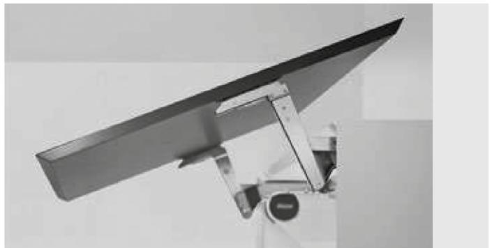
Öffnungsmechanismus für Höhen zwischen 60 - 72 cm, **BLUM AVENTOS HS TOP**, bei dem sich die Front über den Korpus hinaus öffnet. Leichtes Öffnen, in jeder Position arretierbar und sanftes, leises Schließen dank des BLUMOTION-Systems. Stabilität auch bei breiten Fronten. Optional SERVODRIVE (siehe Abschnitt 3.7). LGA-zertifiziert für über 40.000 Öffnungs- und Schließzyklen.
