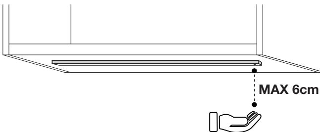
**!**  Il sensore IR è un interruttore ottico che si attiva a seguito di una schermatura dello stesso. Fonti di vapore eccessivo dirette sull'interruttore, potrebbero comportare l'accensione e/o lo spegnimento della lampada. /
