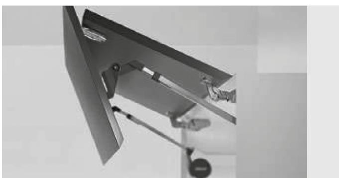
Meccanismo previsto per altezze comprese tra 72 e 120 cm, basato sul sistema **BLUM AVENTOS HF top**, per cui il frontale a due pezzi si piega al centro durante l'apertura. Facile apertura, bloccabile in qualsiasi posizione, chiusura dolce e silenziosa grazie al sistema BLUMOTION. Regolazione tridimensionale di entrambi i frontalì e stabilità anche in caso di frontalì larghi. Opzionale SERVODRIVE (vedi paragrafo 3.7). Certificato LGA per oltre 40.000 cicli di apertura-chiusura.
