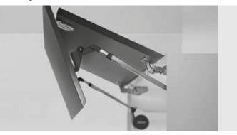
Öffnungsmechanismus für Höhen zwischen 72 und 120 cm, BLUM AVENTOS HL TOP, bei dem sich die Front parallel zur Vorderkante des Korpus öffnet. Leichtes Öffnen, in jeder Position arretierbar, sanftes und leises Schließen dank des Systems BLUMOTION. Dreidimensionale Einstellung der beiden Fronten und Stabilität auch bei breiten Fronten. Optional SERVODRIVE (siehe Abschnitt 3.7). LGA-zertifiziert für über 40.000 Öffnungs- und Schließzyklen.
