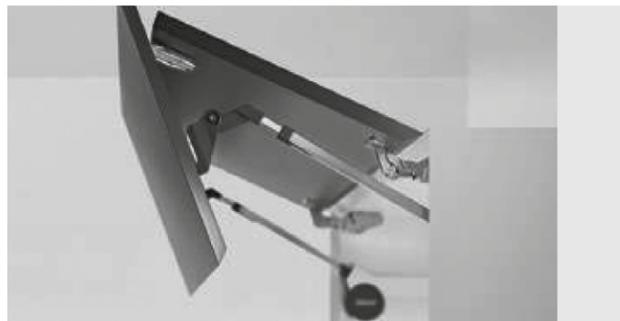
Meccanismo previsto per altezze comprese tra 72 e 120 cm, basato sul sistema **BLUM AVENTOS HF top**, per cui il frontale a due pezzi si piega al centro durante l'apertura. Facile apertura, bloccabile in qualsiasi posizione, chiusura dolce e silenziosa grazie al sistema BLUMOTION. Regolazione tridimensionale di entrambi i frontali e stabilità anche in caso di frontali larghi. Opzionale SERVODRIVE (vedi paragrafo 3.7). Certificato LGA per oltre 40.000 cicli di apertura-chiusura.
